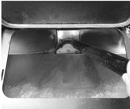
Fig. 33 - Reiniging van de voorraadbak en transportschroef
