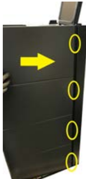
Fig. 35 - Maak het zijpaneel los
